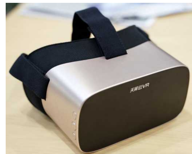
图表：电信天翼VR——小V一体机使用全志VR9芯片
